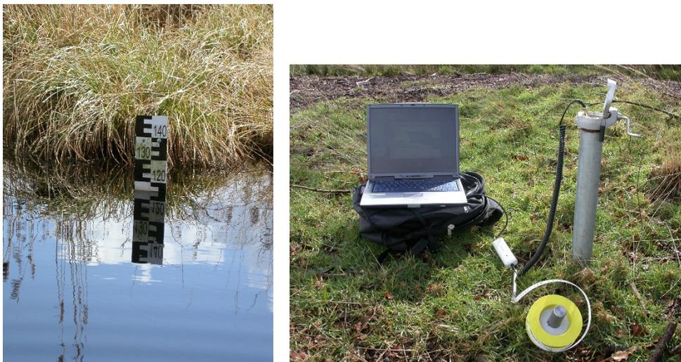
**Abb. 21:** Wasserstandmesseinrichtungen für ein hydrologisches Messnetz.
